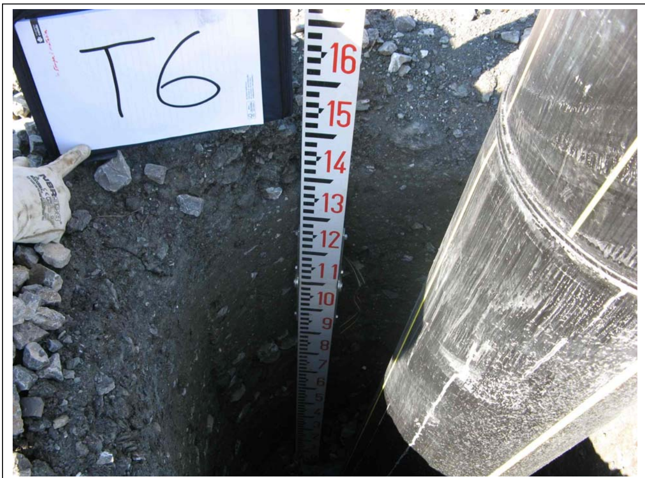
Foto 11: Misura argilla di copertura del sondaggio T6
