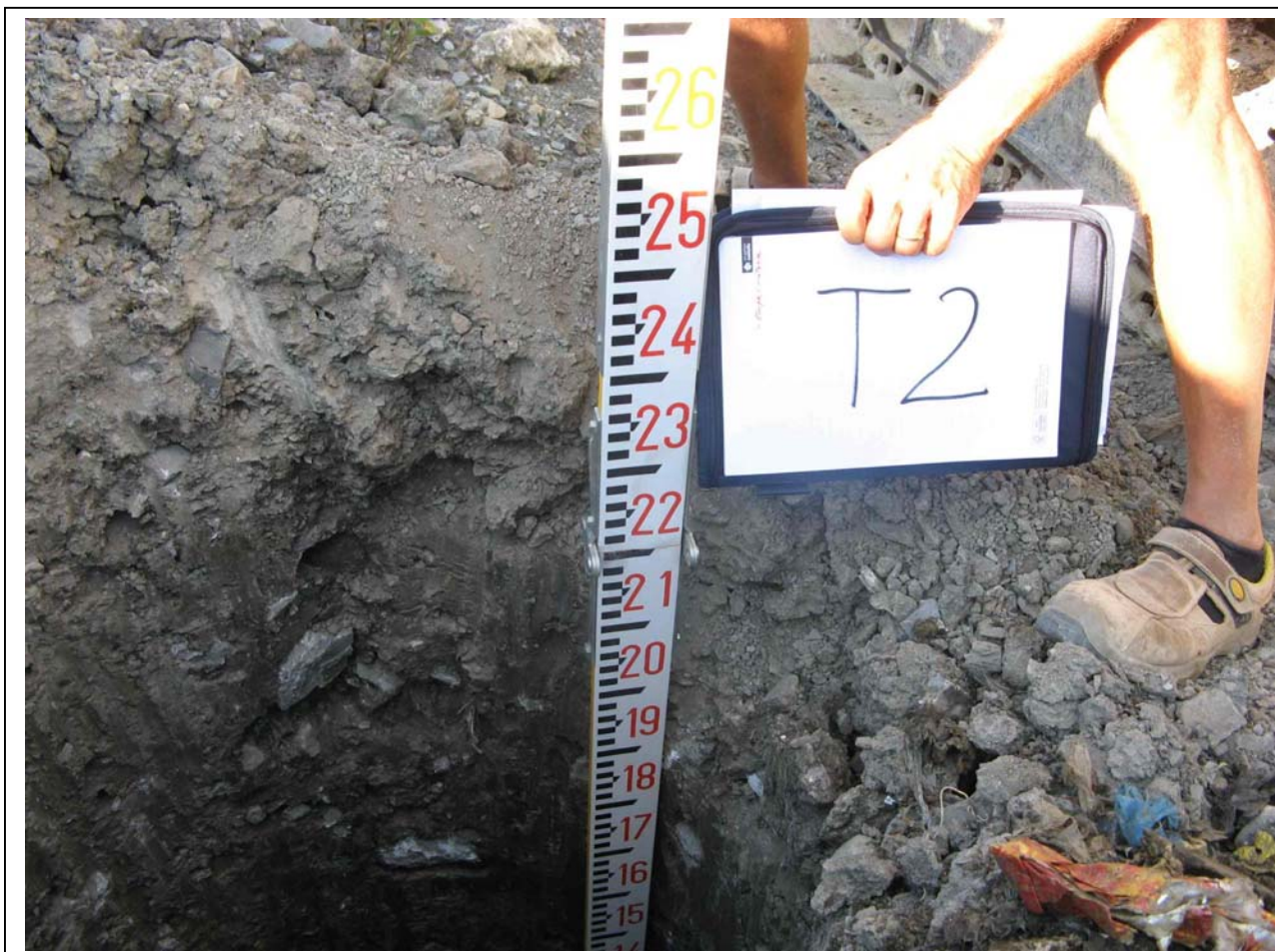
Foto 5: Misura argilla di copertura del sondaggio T2
