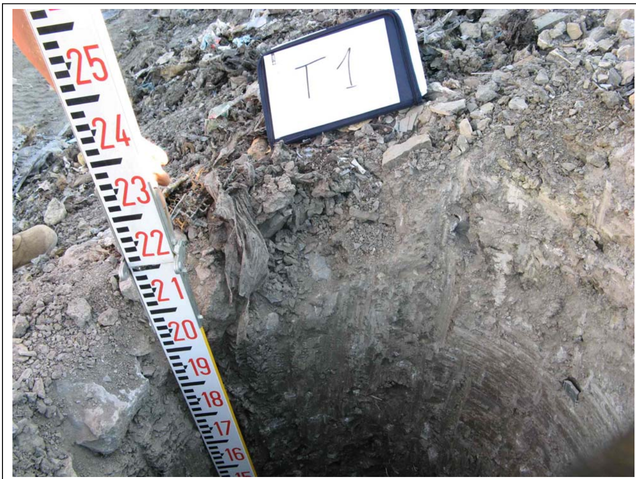
Foto 4: Misura argilla di copertura del sondaggio T1
