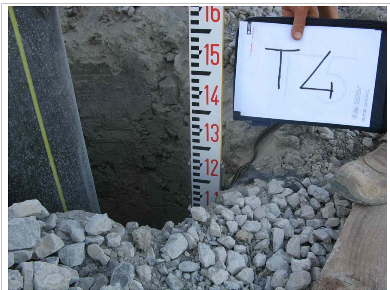
Foto 7: Misura argilla di copertura del sondaggio T4
