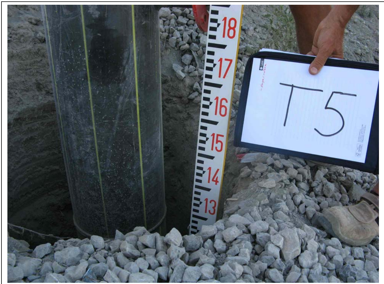
Foto 10: Misura argilla di copertura del sondaggio T5
