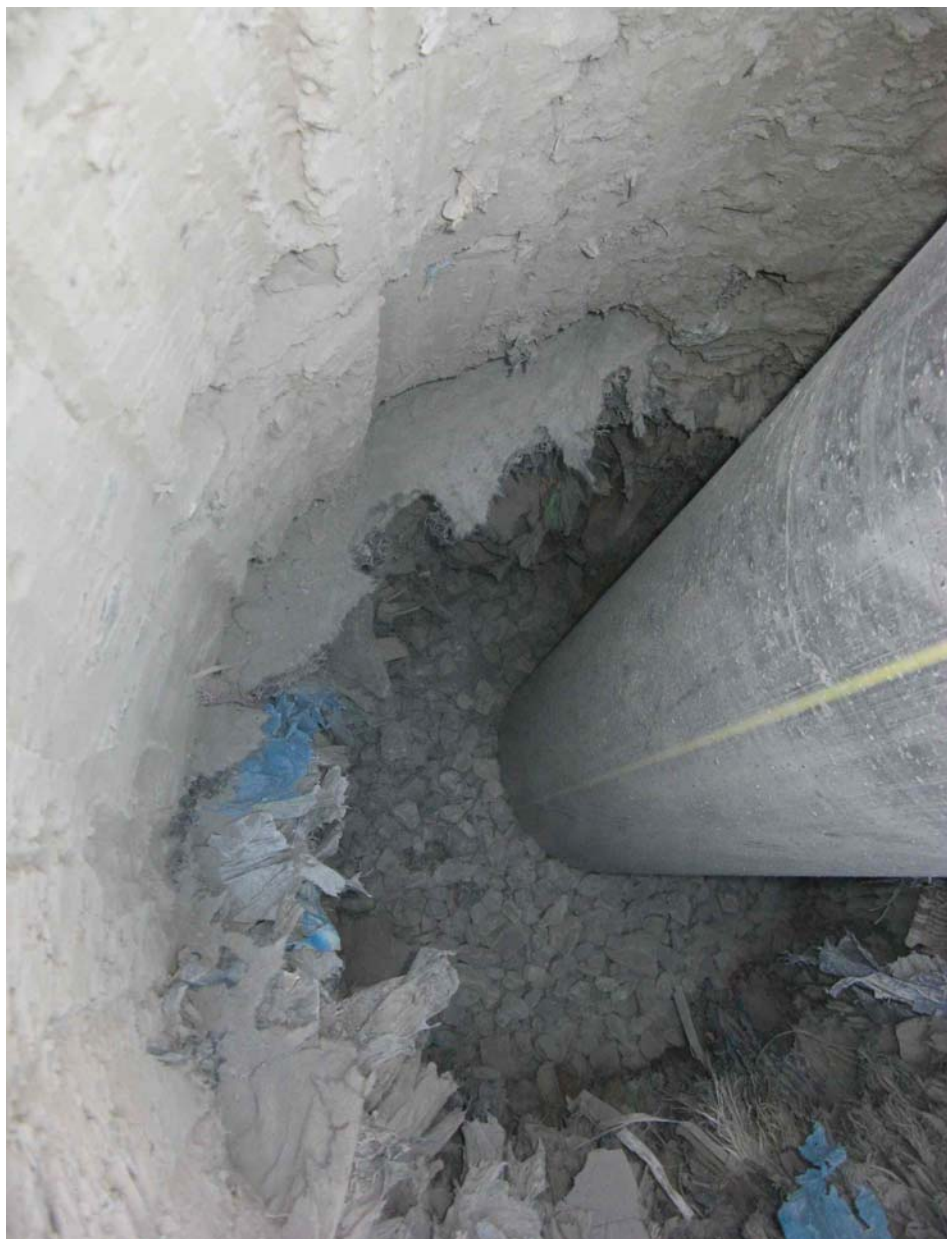
Foto 8: Particolare della trivellaz T4 con evidenza della presenza del materassino drenante (bordo bianco in alto a sinistra) tra rifiuto ed argilla di copertura.
