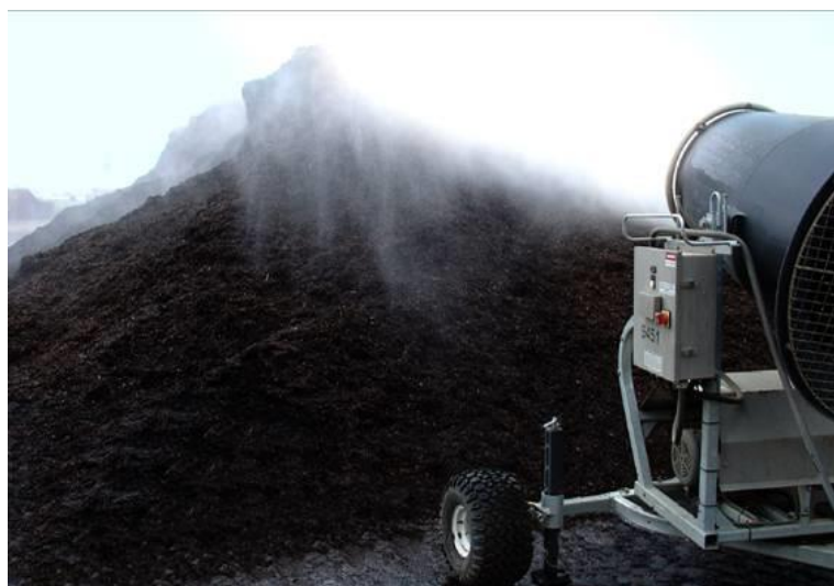
Figura 10: Esempio di umidificazione di cumulo di materiale sciolto
