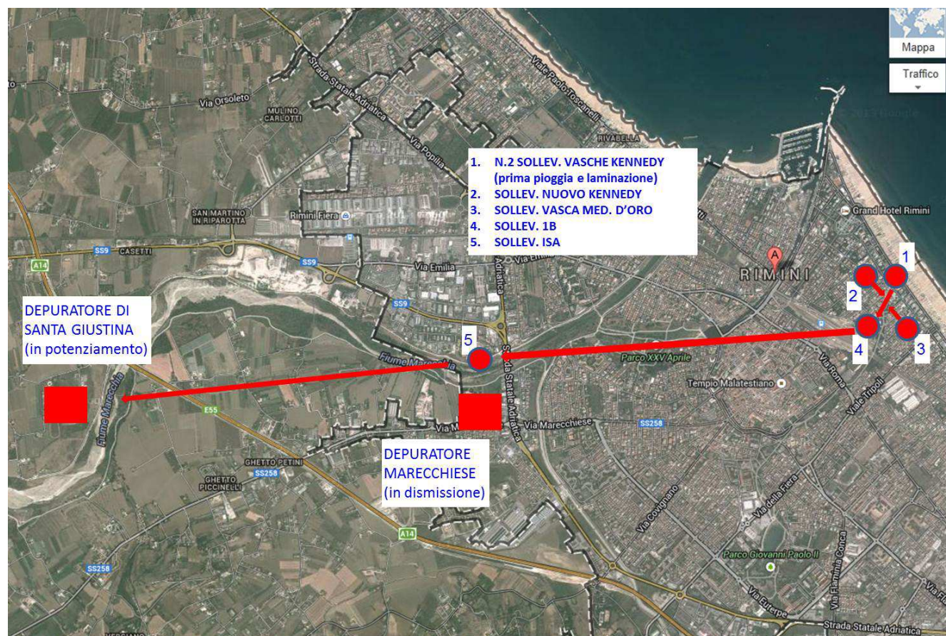
Figura 4. Rappresentazione schematica percorso idraulico reflui dalle Nuove Vasche fino alla Impianto di depurazione di Santa Giustina.
