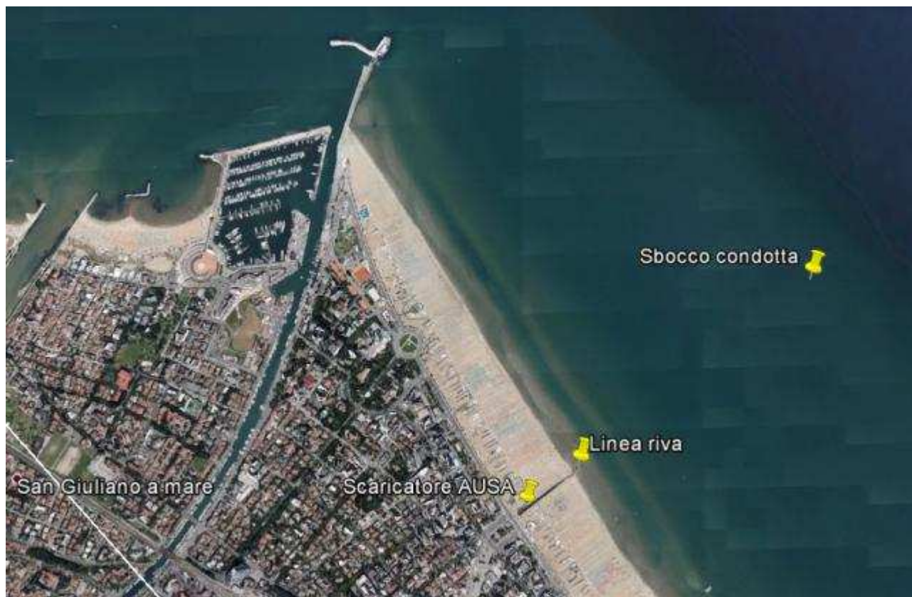
Fig. 5.1.1: posizionamento geografico dello scarico da condotta sottomarina considerato nelle simulazioni preliminari.
