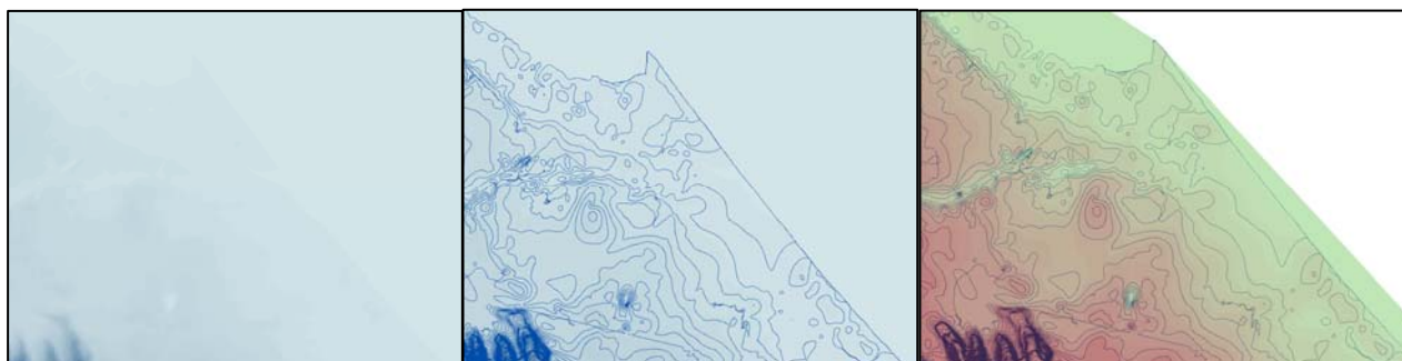
Figura 3. Step successivi per l'ottenimento del DTM di Rimini.
