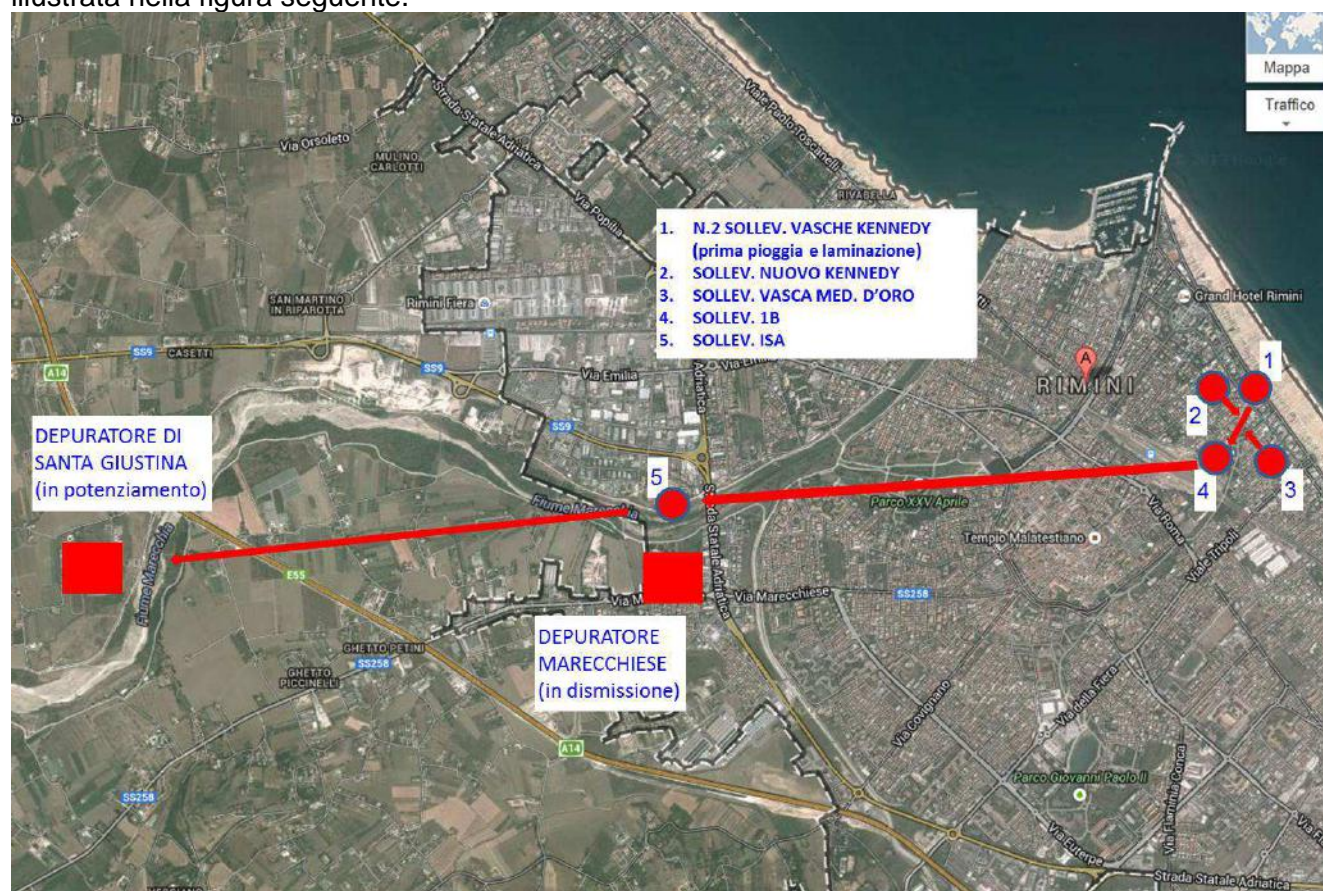
Figura 3. Rappresentazione schematica percorso idraulico reflui dalle Nuove Vasche fino alla Impianto di depurazione di Santa Giustina.
