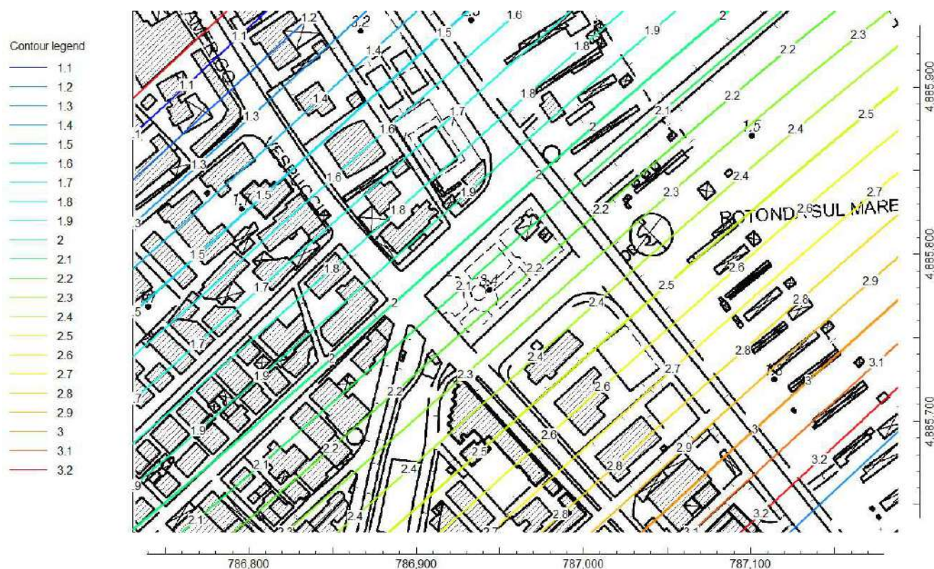
Figura 26 - Ricostruzione della piezometrica nelle condizioni ante operam nella falda confinata A1.
