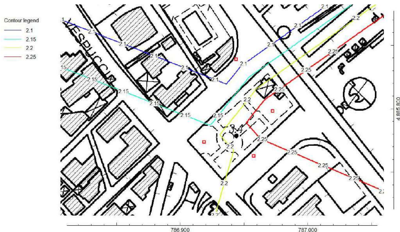
Figura 23 - Ricostruzione della piezometrica nell'acquifero A1 sulla base dei dati del monitoraggio eseguito il 17/03/2015 (massimo livello in corso di monitoraggio).
