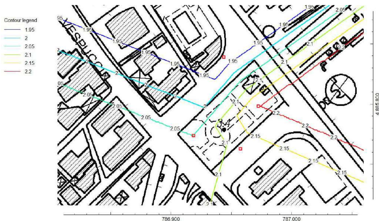
Figura 24 - Ricostruzione della piezometrica nell'acquifero A1 sulla base dei dati del monitoraggio eseguito il 11/10/2014 (minimo livello in corso di monitoraggio).
