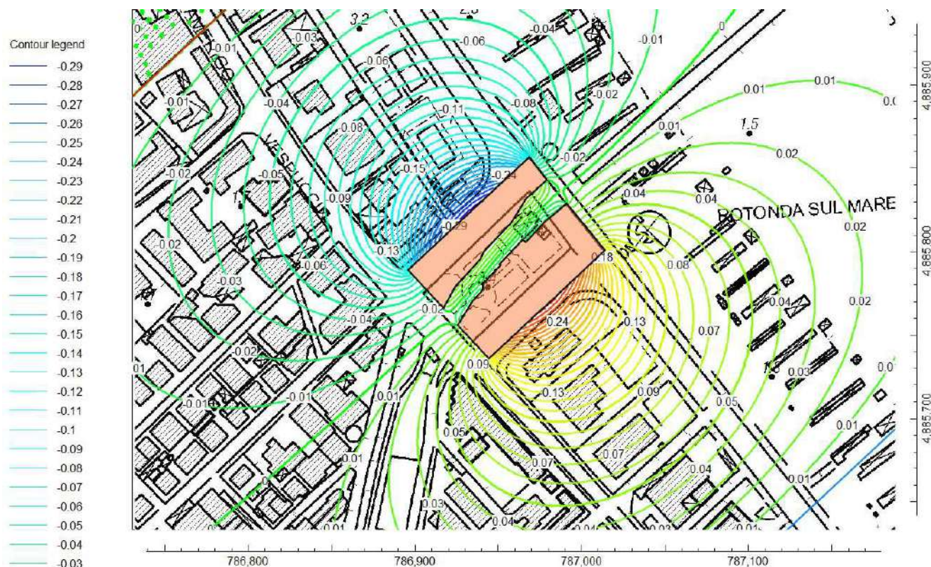
Figura 28 - Variazione del carico idraulico nella falda A1 fra la condizione post operam e la condizione ante operam. Le isolinee sono tracciate ogni 0.01 m. I valori positivi corrispondono agli innalzamenti mentre i valori negativi agli abbassamenti.
