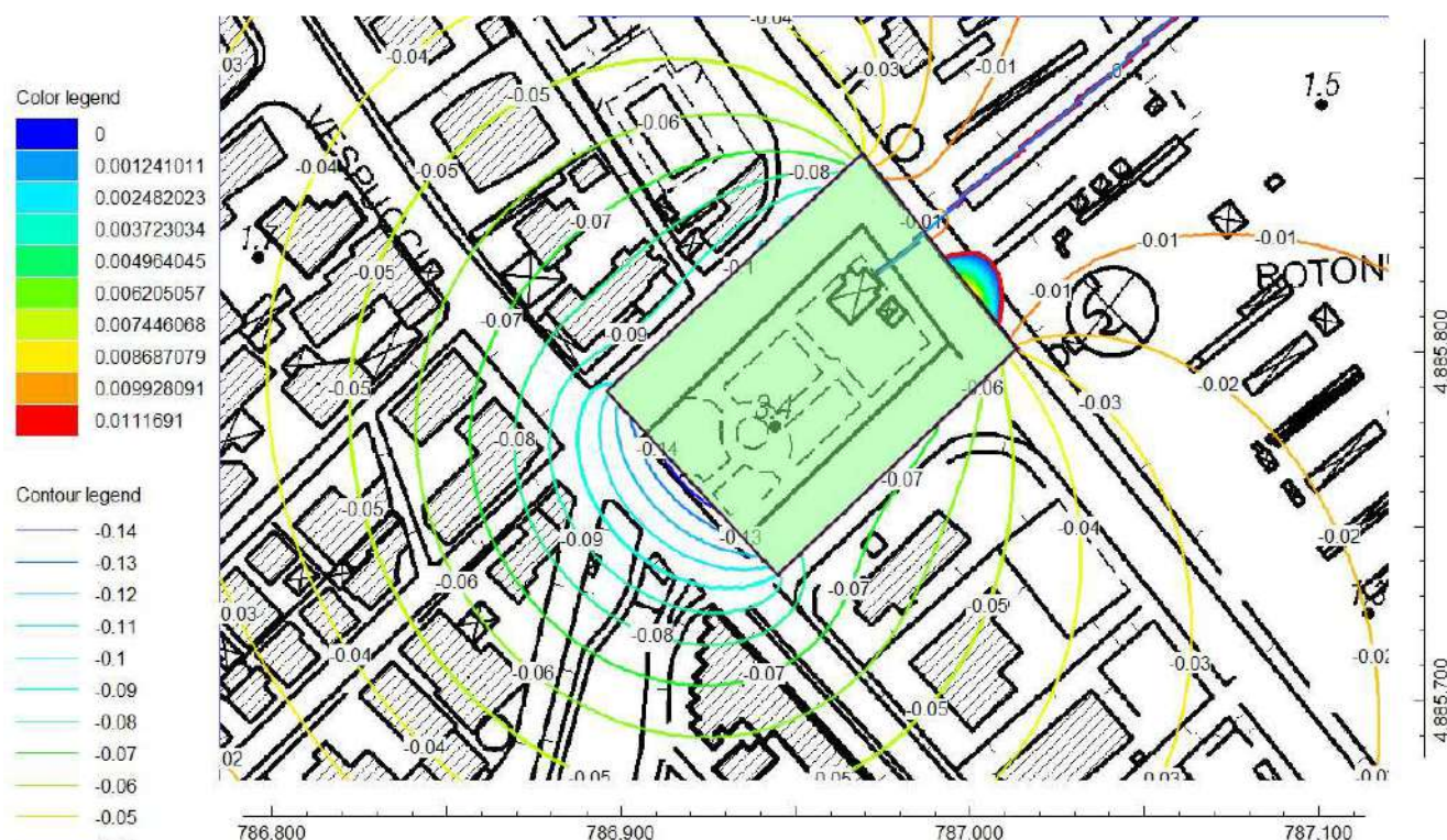
Figura 22 - Differenza in metri fra l'andamento delle isofreatiche nella condizione di vasca unica senza corridoio e le condizioni ante operam.
