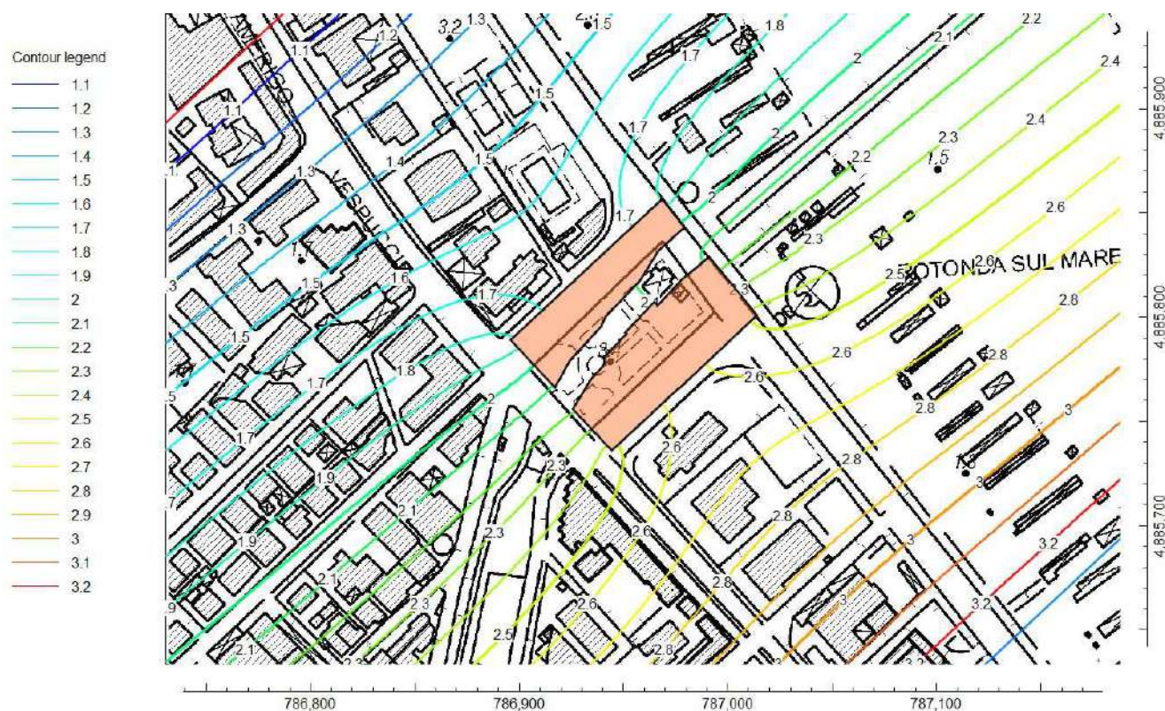
Figura 27 - Ricostruzione della piezometrica nelle condizioni post operam nella falda A1. In rosa: vasche Ausa.
