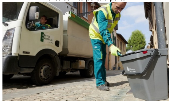
Figura 2.13 Lettura di un transponder durante le operazioni di svuotamento di un contenitore dei rifiuti indifferenziati in area servita porta a porta
